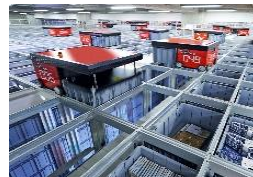
自動倉庫型 ピッキングシステム
