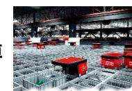
立体自動倉庫
