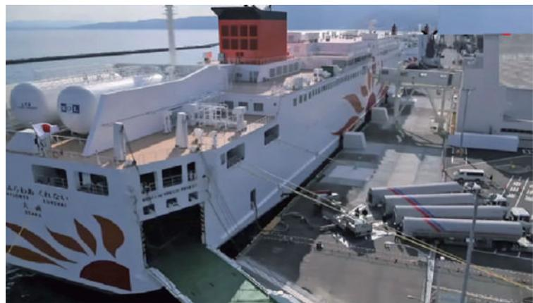
タンクローリー4台によるLNG燃料供給(Truck to Ship方式)
