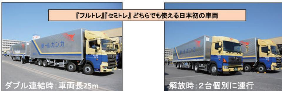
(4)車両長25m ダブル連結トラックの導入
