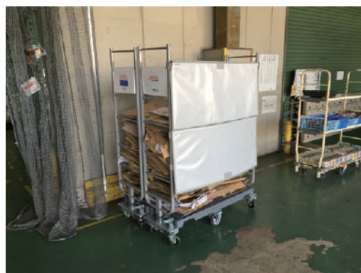
6輪カートで段ボール古紙を運ぶための試作品
